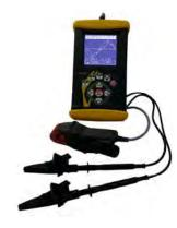
Otra innovación es el empleo de minipinzas flexibles como sondas de corriente. Esta característica mejora significativamente la potabilidad y la manejabilidad del instrumento, reduciendo el peso y las dimensiones, pero sin limitar las posibilidades de medición.
